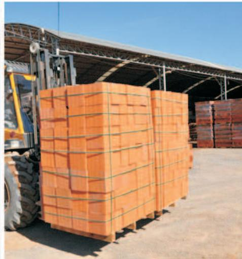
O Posicionador Duplo de Garfos produzido pela Saur está sendo utilizado para movimentar cargas de tijolos. O equipamento que já demonstra bons resultados na movimentação de bebidas, agora mostra sua eficiência, também, no segmento cerâmico.
