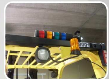
Foto 5: O conjunto de luzes sobre a empilhadeira identificam à distância a pressão que está sendo exercida sobre o produto.
