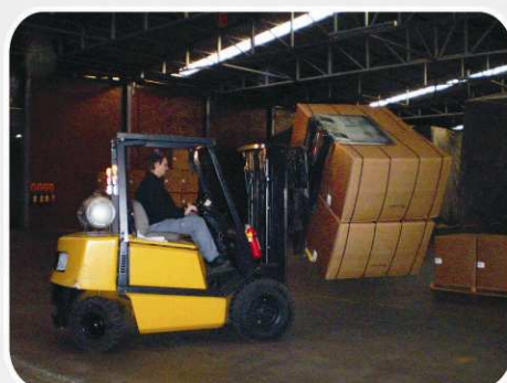
Garra com Encaixe nos Garfos Acesso superior. Fácil remoção.
