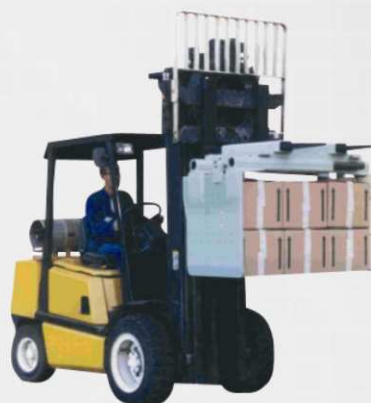
Garra com Encaixe nos Garfos Acesso superior. Fácil remoção.
