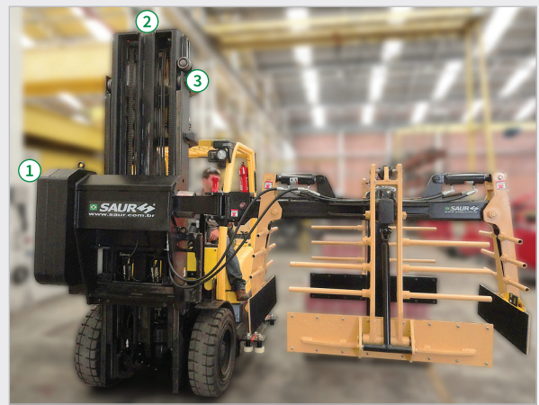
1 - Contrapeso Lateral | 2 - Guia para Torre | 3 - Roldana para Torre
