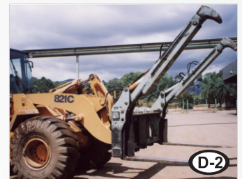
D - Después de bajar los brazos más grandes, los brazos más pequeños abren, presionando los tubos paralelamente a las horquillas.
