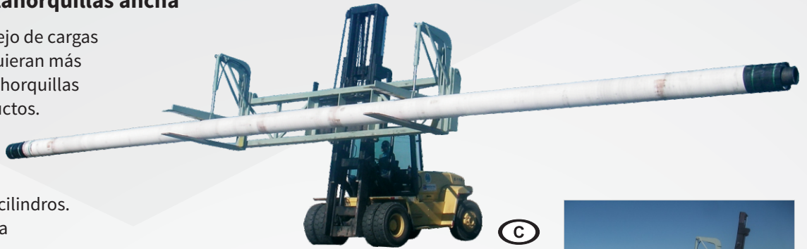
C - Fijador con portahorquillas de 7500 mm de ancho, cargando tubos de 24 m.
