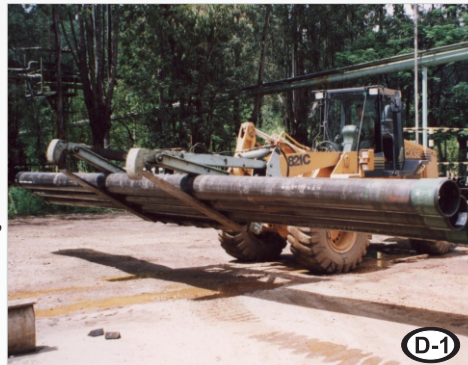
D - Después de bajar los brazos más grandes, los brazos más pequeños abren, presionando los tubos paralelamente a las horquillas.
