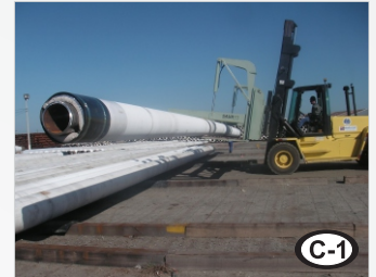
C - Fijador con portahorquillas de 7500 mm de ancho, cargando tubos de 24 m.
