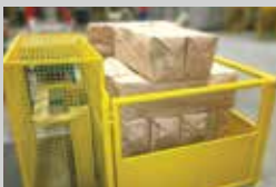
Torre de Elevação Fixa instalada em fosso para melhorar a ergonomia do operador durante a montagem dos paletes.
