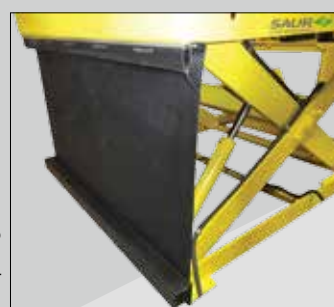
Dispositivos de segurança no perímetro externo da Plataforma, impedem o acesso e interrompem o movimento de descida ao encontrar qualquer obstáculo, evitando o efeito guilhotina.
